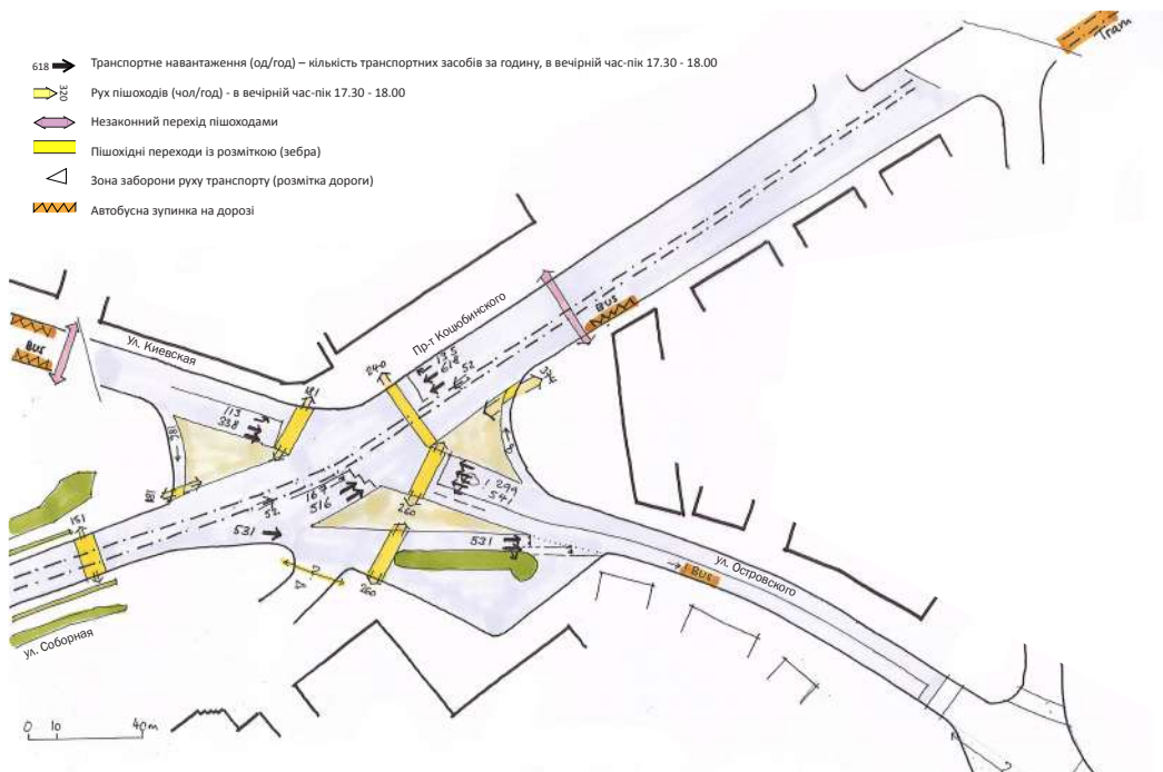
Схема: Перехрестя на Жовтневій пл., існуюча геометрія, пішохідні переходи і транспортна завантаженість у 17:30-18:30
